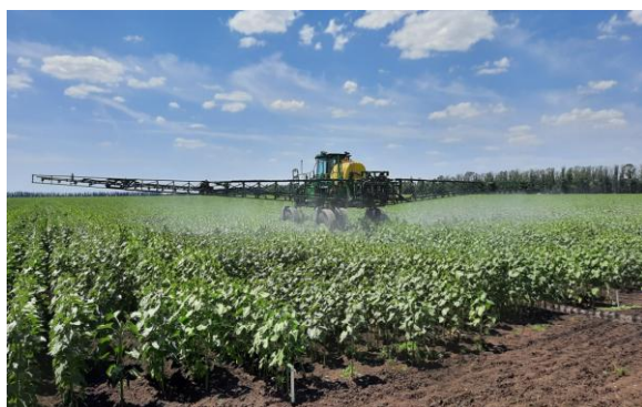
Рисунок 1 – Внесение препаратов на подсолнечнике самоходным широкозахватным опрыскивателем с высоким клиренсом Dohn Deere M 4030 (ориг.)
